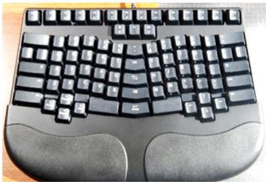
Εικόνα 4.4 Αριστερά: Πληκτρολόγιο δύο σταθερών τμημάτων της εταιρείας Truly Ergonomic. Πηγή: commons.wikimedia.org . Δεξιά: Πληκτρολόγιο ανεξάρτητων τμημάτων της εταιρείας Apple. Πηγή: commons.wikimedia.org .
