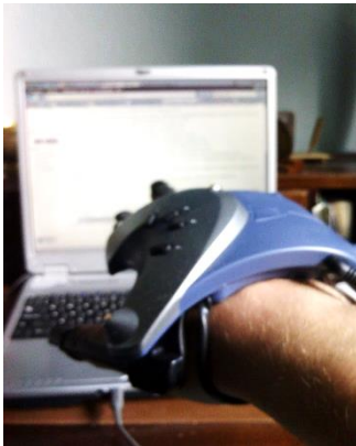
Εικόνα 4.13 Γάντι δεδομένων που χρησιμοποιείται ως δεικτική συσκευή. Πηγή: commons.wikimedia.org .
