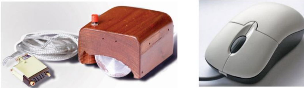
Εικόνα 4.6 Αριστερά: Το πρώτο μηχανικό ποντίκι όπως υλοποιήθηκε από τον εφευρέτη του Douglas Engelbart. Πηγή: commons.wikimedia.org . Δεξιά: Ποντίκι laser με δύο πλήκτρα και ρόδα κύλισης της εταιρείας Microsoft. Πηγή: commons.wikimedia.org .
