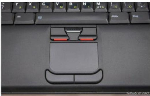
Εικόνα 4.10 Αριστερά: Επιφάνεια επαφής ενσωματωμένη σε φορητό υπολογιστή (προϊόν ThinkPad R51 της εταιρείας IBM). Πηγή: flickr.com . Δεξιά: Επιφάνεια επαφής με δυνατότητες ενσύρματης και ασύρματης σύνδεσης (προϊόν Lofree MT-100). Πηγή: flickr.com .
