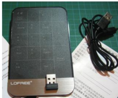
Εικόνα 4.10 Αριστερά: Επιφάνεια επαφής ενσωματωμένη σε φορητό υπολογιστή (προϊόν ThinkPad R51 της εταιρείας IBM). Πηγή: flickr.com . Δεξιά: Επιφάνεια επαφής με δυνατότητες ενσύρματης και ασύρματης σύνδεσης (προϊόν Lofree MT-100). Πηγή: flickr.com .
