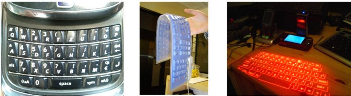
Εικόνα 4.3 Αριστερά: Πληκτρολόγιο QWERTZ μικρών διαστάσεων στο BlackBerry Torch. Πηγή: commons.wikimedia.org . Κέντρο: Εύκαμπτο πληκτρολόγιο της εταιρείας Micro Innovations. Πηγή: commons.wikimedia.org . Δεξιά: Εικονικό πληκτρολόγιο προβαλλόμενο σε επιφάνεια. Πηγή: commons.wikimedia.org .
