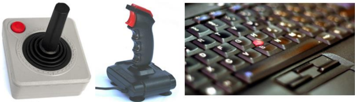
Εικόνα 4.8 Αριστερά: Ισοτονικό χειριστήριο joystick με 1 πλήκτρο της εταιρείας Atari. Πηγή: commons.wikimedia.org . Κέντρο: Ισοτονικό χειριστήριο joystick με 2 πλήκτρα της εταιρείας Sinclair Research. Πηγή: flickr.com . Δεξιά: Ισομετρικό χειριστήριο με 3 πλήκτρα (προϊόν TrackPoint της εταιρείας IBM). Πηγή: flickr.com .
