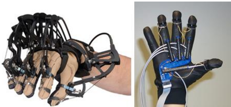
Εικόνα 6.5 Αριστερά: Συσκευή CyberGrasp της εταιρίας Immersion, με πέντε βαθμούς ελευθερίας απτικής ανάδρασης, έναν για κάθε δάκτυλο. Δεξιά: Συσκευή Rutgers Master II του πανεπιστημίου Rutgers, με τέσσερις βαθμούς ελευθερίας απτικής ανάδρασης, έναν για κάθε δάκτυλο εκτός από το μικρό.
