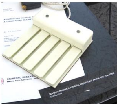
Εικόνα 4.5 Αριστερά: Πληκτρολόγιο χορδής ενός χεριού. Πηγή: flickr.com . Δεξιά: Πληκτρολόγιο ειδικού σκοπού ενός χεριού της εταιρείας MALTRON (από τη συλλογή του Bill Buxton). Πηγή: flickr.com .
