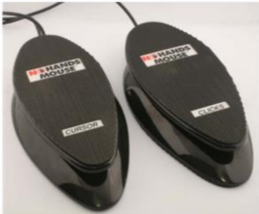
Εικόνα 4.12 Αριστερά: Δεικτική συσκευή εδάφους (προϊόν No Hands Mouse της εταιρείας Curson, από τη συλλογή του Bill Buxton). Πηγή: Αβούρης (2000). Δεξιά: Δεικτική συσκευή προσαρμοσμένη στο κεφάλι (head-stick ή head-wand) ενός χρήστη με τετραπληγία. Πηγή: en.wikimedia.org .
