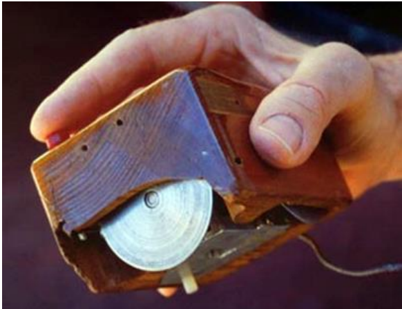
Εικόνα 1.5 Το πρωτότυπο του ποντικιού που κατασκευάστηκε από τους D. Engelbart και B. English . Ο Engelbart έκανε αίτηση για δίπλωμα ευρεσιτεχνίας για το ποντίκι το 1967. Το ονόμασε "x-y position indicator." Η περιγραφή στην αίτηση αναφέρει: Ο X-Y position indicator κινείται με το χέρι σε κάποια επιφάνεια ώστε να κινήσει το δρομέα (cursor) σε οθόνη καθοδικού σωλήνα.
